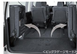
4列目シートには、左右両サイドに簡単に跳ね上げて格納できるスペースアップ機能を採用。荷物の量・サイズ・形状にフレキシブルに対応します。
