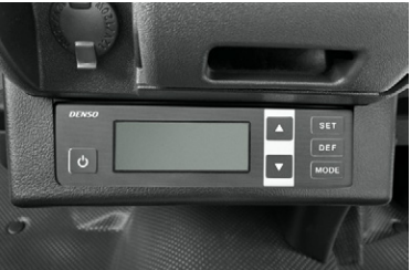
31 コントロールパネル移設 ナビゲーションシステム等で、大型センターポケット全体を使用する場合は必ず選択ください。 (注) 足元スペースが狭くなります。
