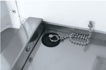
19 フロアサイド水止め&水抜き穴追加 (後左側) バックドア部に25mmの水止めを設置し、左側に水抜き穴を追加します。
