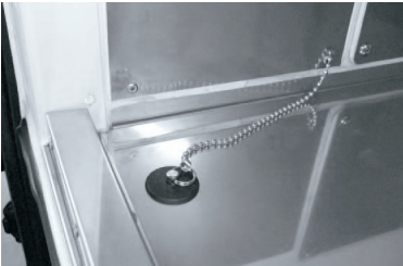
17 フロアサイド水止め&水抜き穴追加 (前左側) サイドドア部に25mmの水止めを設置し、水抜き穴を追加します。
