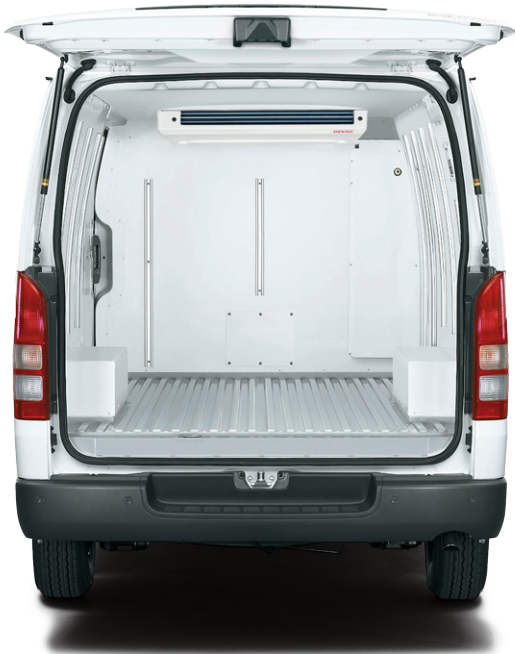
車型番号 10 photo: 中温冷凍バン・標準フロア・4WD・ディーゼル車 (3DF-GDH206V-VTBPTB)
