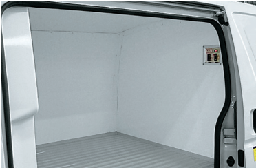
24 荷室内間仕切り(固定式) 荷室内を仕切ること、荷物の積み分けができます。 床面長さ:前室1,335mm、後室1,315mm (ジャストローは1,320mm)。
