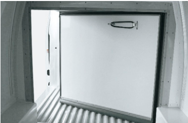
25 荷室内間仕切り(開閉式) 積荷の量や用途に応じて、荷室を変更できます。 前方から1,280mmに取り付け(前開き)、ハンドルにて開閉でき簡易固定が可能です。
