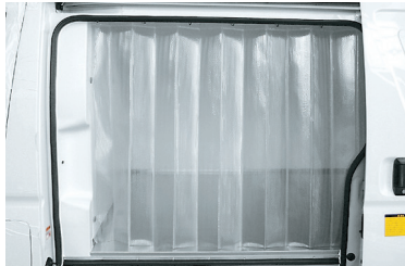
㉓ カーテン(サイドドア用) サイドドアからの冷気の流出を抑えます。
