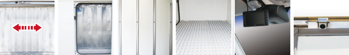
⑫ バックドア用カーテン ⑬ サイドドア用カーテン ⑭ アルミエアリブ（断面 m 型） ⑮ 樹脂スノコ（抗菌タイプ） ⑯ バックモニター（インナーミラータイプ） バックカメラ
