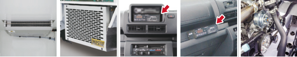
Ⓐ クーリングユニット Ⓑ アンダーマウントコンデンサー Ⓒ コントロールパネル DIN スペース取付（オーディオレス時） コントロールパネル 助手席トレイ取付（オーディオ有り時） 2 コンプレッサー方式 メインエンジン直結式 ベルト駆動
