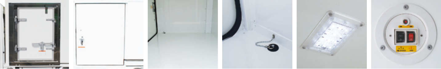
⑥ 低温冷凍車の場合 オープン式左サイドドア（前ヒンジ） ⑦ 中温冷凍車の場合 スライド式左サイドドア ⑧ 亜鉛引き鋼板（ホホワイト塗装） ⑨ 水抜き穴（ゴム栓付）庫内（前方左） ⑩ 庫内ルームランプ（LED 灯） ⑪ 非常警報ブザー
